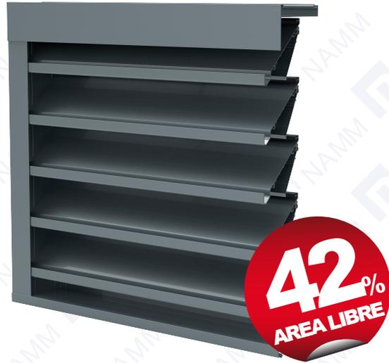
**CONSTRUCCION:** Marcos y aletas drenables de perfiles de aluminio extruido de 0.065" de espesor, aleación 6063-T5 de gran resistencia a la corrosión.
