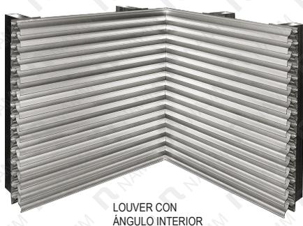
Para asegurar un correcto ensamble en esquina en 90° (hacia adentro ó hacia afuera) Se utiliza un ángulo especial de aluminio el cual se inserta en la vena interior de la aleta y se remacha mediante una pinza especial con superficie plana exterior, contra un pico interno que deforma la vena contra el ángulo esquinero.
