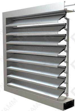
**CONSTRUCCION:** Marcos y aletas fijas de perfiles de aluminio extruido de 0.060" de espesor y gran resistencia a la corrosión, aleación 6063-T5, Aletas barométricas en lámina de aluminio cal # 24.
